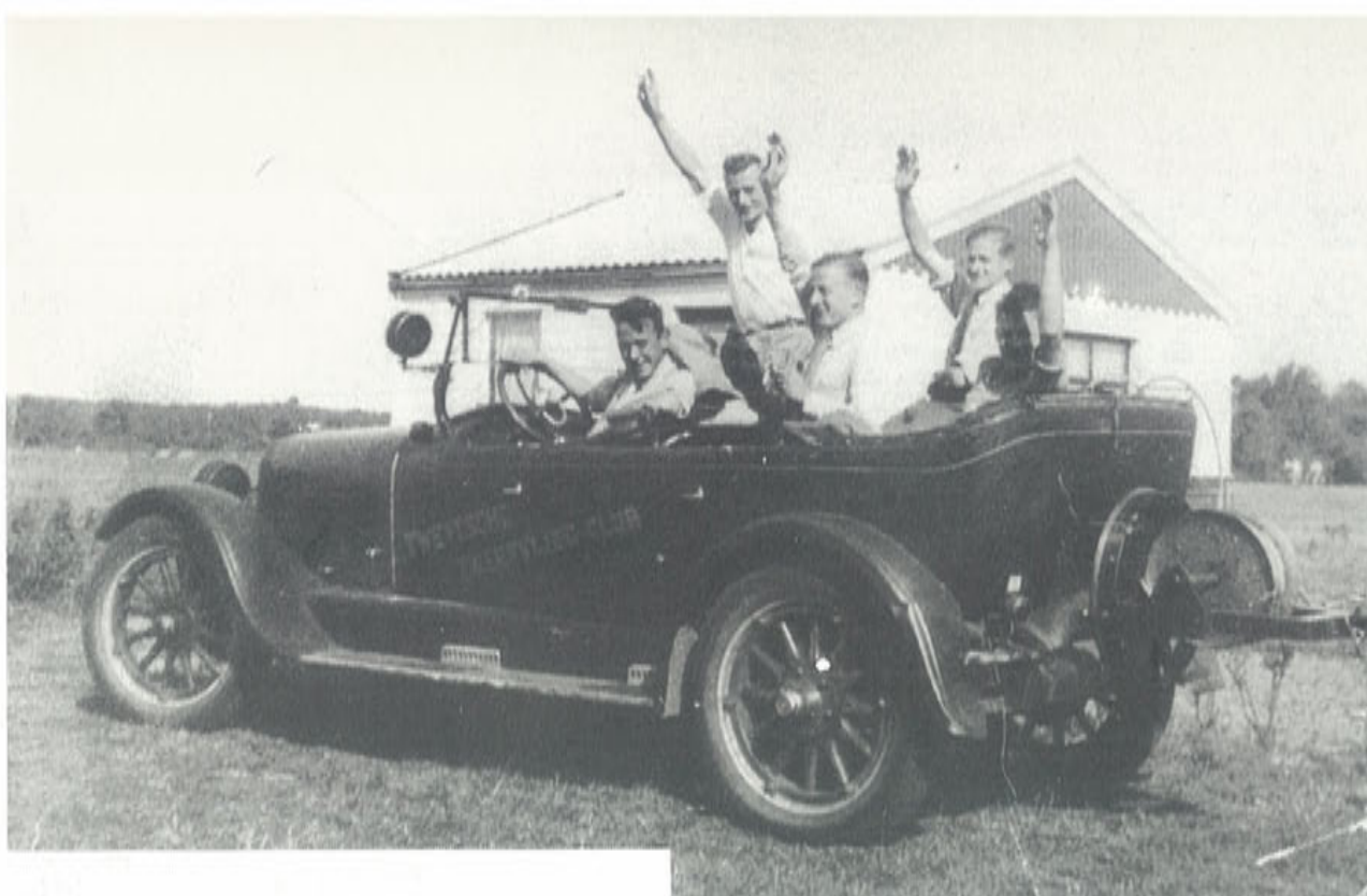
De sleepauto van de TZC met v.l.n.r.: Bosman, Wijkens, Brettschneider, J. Rokker, F. Rokker en Rietman. Achter de auto is zichtbaar de sleepkabelbevestiging met ont-koppelhaak en kabelhaspel.
